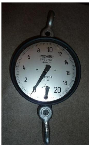
Рисунок 1 – Общий вид динамометров ДПУ-20, ДПУ-50, ДПУ-100
