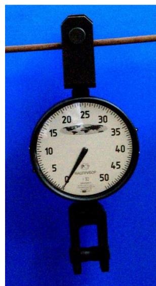
Рисунок 2 – Общий вид динамометров ДПУ-200, ДПУ-500
