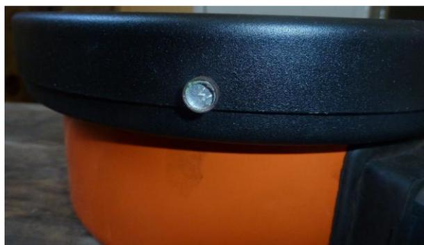
Рисунок 3 – Место пломбировки от несанкционированного доступа
