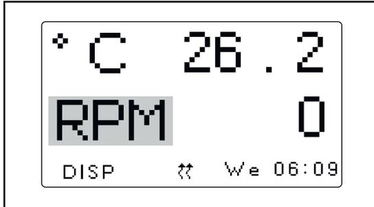
1. Поверните **ручку управления**, чтобы выделить параметр, который следует заменить. В этом примере показано изменение параметра с *RPM* на *HRS*.
