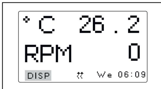
1. Поверните **ручку управления** чтобы выделить *DISP* в нижнем левом углу экрана.
