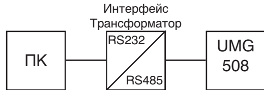
Иллюстрация. Подключение UMG508 к ПК с использованием преобразователя интерфейса
