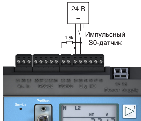
Рис. 41.1. UMG604 со входами на 24 В. Пример с импульсным S0-датчиком.
