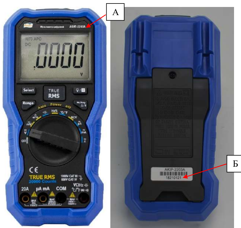
Рисунок 1 – Общий вид мультиметров, места нанесения знака утверждения типа (А) и серийного номера (Б)
