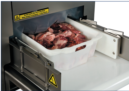
Анализ мяса в лотках, коробках или без упаковки на конвейере
