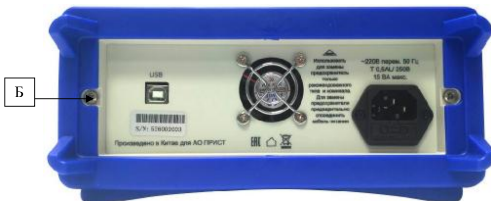
Рисунок 4 – Вид задней панели вольтметров АКІП-2404, АКІП-2405 и место пломбировки от несанкционированного доступа (Б)
