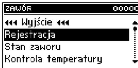
В этой функции установщик вписывается серийный номер модуля, управляющего сервомотором трёхходового клапана (**ST-61**, это пятизначный номер, находящийся на корпусе этого модуля). Без этого номера функция не будет активна.
