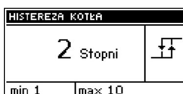
Этот режим служит для установки гистерезиса заданной температуры Ц.О. Это разница между температурой входа в цикл поддержки и температурой возврата в рабочий цикл (напр. когда заданная температура установлена на 60°C, а гистерезис составляет 3°C, переход в цикл поддержки наступит после достижения температуры 60°C, а возврат в цикл работы наступит после понижения температуры до 57°C).
