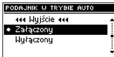
Это возможность включения или выключения автоматической работы подавателя. Подаватель можно выключить для ручной подачи топлива или для того, чтобы вызвать погашение котла.
