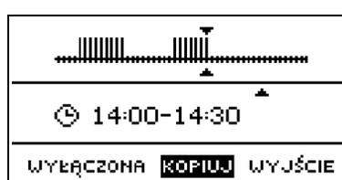
Эта функция служит для управления насосом, смешивающим горячую воду между котлом и приемниками воды горячего снабжения. Пользователь при помощи этой функции настраивает суточный цикл активации или простоя насоса с точностью до 30 минут.
