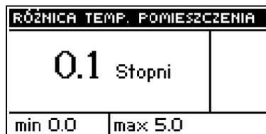
Эта настройка определяет единичное изменение и текущей температуры комнаты (с точностью до 0,1°C), при которой произойдет определенное изменение заданной температуры клапана (функция активна только с комнатным регулятором TECH).
