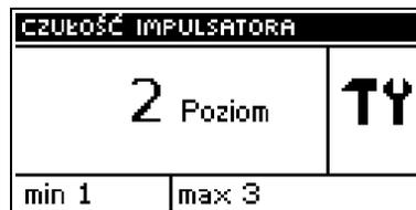
При помощи этой настройки можно изменить чувствительность ручки импульсатора в пределах от 1 до 3 (где 1 - наивысшая чувствительность).
