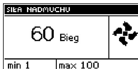
Эта функция управляет скоростью работы вентилятора. Область регулировки находится в пределах от 10 до 100%, (можно принять, что это скорости вентилятора). Чем выше скорость, тем быстрее работает вентилятор, где 10% - минимальная скорость вентилятора, а 100% - максимальная работа вентилятора.
