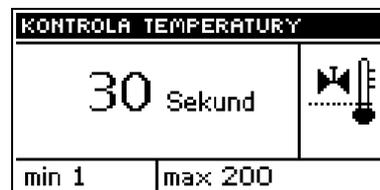
Этот параметр определяет частоту взятия проб (контроля) температуры воды за клапаном системы отопления или горячего водоснабжения. Если датчик указывает на изменение температуры (отклонение от заданного значения), то электроклапан отклонится или прикроется на определенный шаг, чтобы возвратиться к заданной температуре.
