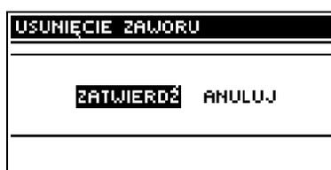
Эта функция служит для полного удаления клапана из памяти контроллера. Удаление клапана используется напр., при демонтаже клапана или замене модуля (необходима повторная регистрация нового модуля).
