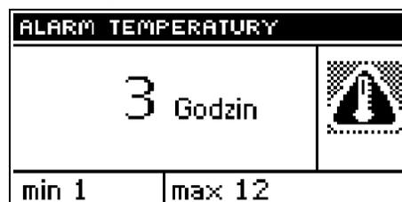
Эта функция включается только в режиме **работы** (если температура котла ниже *заданной температуры*). Если температура котла не растет в течение определенного пользователем времени, срабатывает сигнализация: Выключатся подаватель и наддув (насос воды включается и выключается независимо) и включается звуковой сигнал. На индикаторе показывается сообщение: „**Температура Ц.О. не растет**”. Сигнализация сбрасывается при нажатии на импульсатор.
