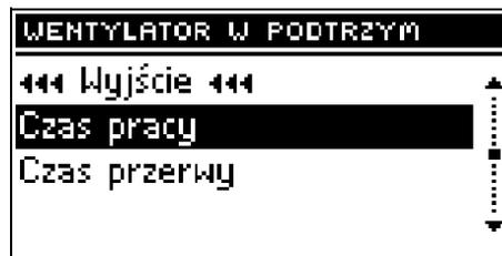
Эта функция позволяет подобрать соответствующее время работы и перерыва в работе вентилятора *в поддержке* (т.н. продува).
