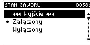
Эта функция позволяет временно выключить активность клапана без необходимости полного его удаления. После повторного включения не требуется регистрация.
