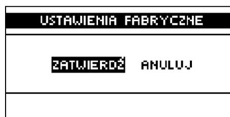
Регулятор предварительно настроен для работы. Однако, его следует привести в соответствие с собственными потребностями. В каждом моменте можно возвратиться к заводским настройкам. Включая функцию **заводские настройки**, теряются все настройки котла, установленные пользователем, а появляются настройки. Записанные производителем. С этого момента можно заново установить собственные параметры котла.
