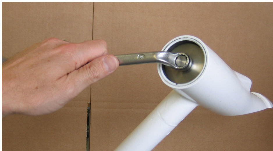
Рис. 47. Снятие стопорного кольца модуля (показано для передатчика)
