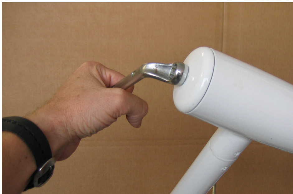
Рис. 46. Снятие концевой заглушки (показано для передатчика)
