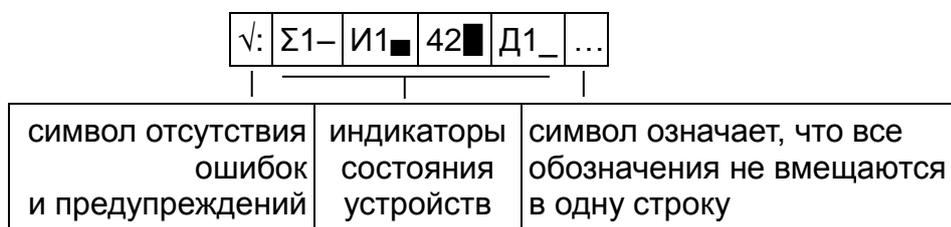
Рисунок 3.5 – Пример статусной строки при отсутствии ошибок и предупреждений
