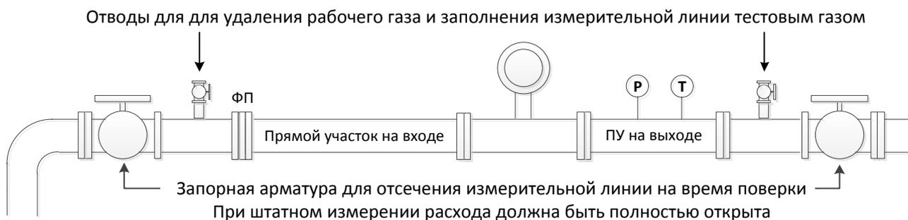
Рисунок М.2 – Компоненты измерительного трубопровода для имитационной поверки
