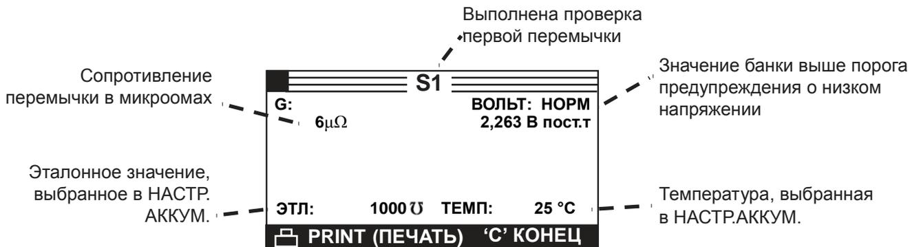
**\*\* ПРИМЕЧАНИЕ:** Прибор отображает и печатает тире (-----), если выбрано ТОЛЬКО НАПР. в НАСТР. АККУМ, или выбрано НАПР. ЗАТЕМ ПРОВОДИМОСТЬ, но измерение проводимости не было завершено.
