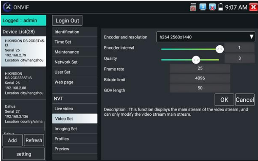
Рис. 29 Настройки видеопотока для IP видеоканеры
