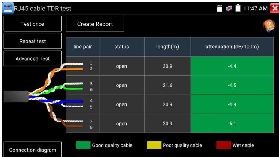
Рис. 102 Интерфейс рефлектометра (TDR) для кабеля «витой пары»
