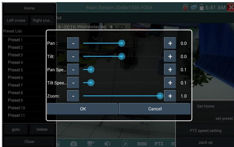
Рис. 45 Настройки горизонтальной и вертикальной скорости PTZ
