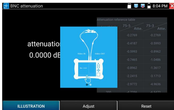
Рис. 123 Подключение кабеля для определения степени затухания
