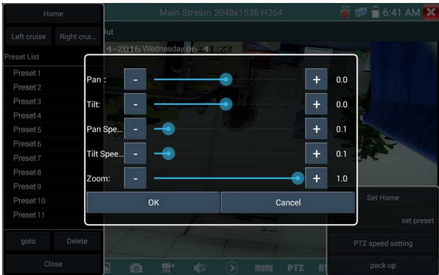
Рис. 53 Настройки горизонтальной и вертикальной скорости PTZ
