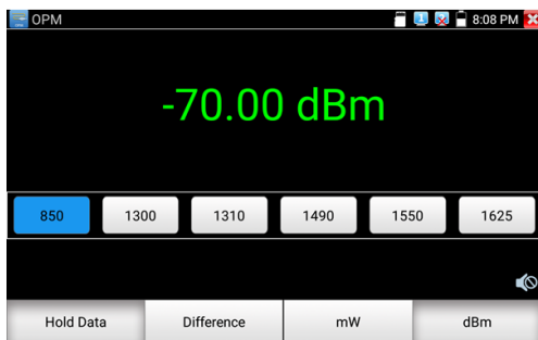
Рис. 131 Использование функции удержания последнего измерения и измерения относительной мощности
