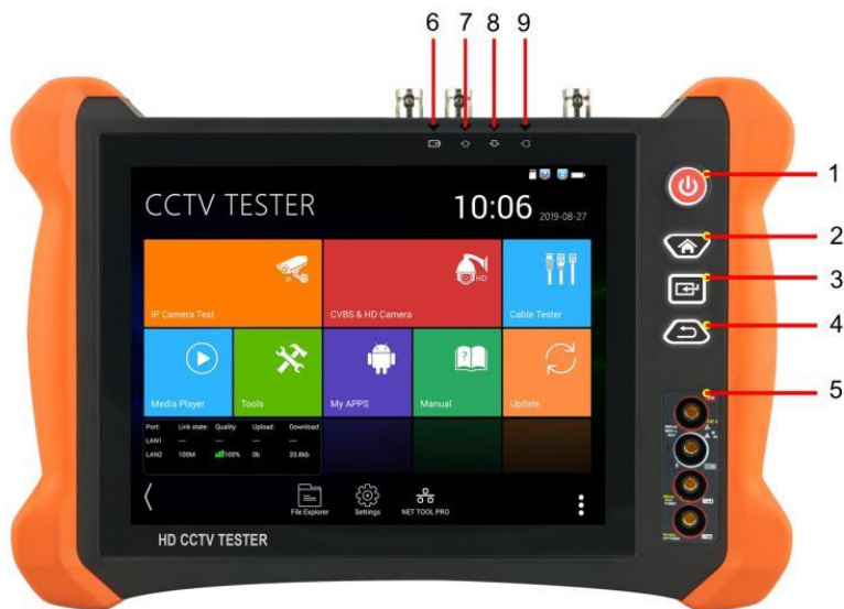
Рис. 4 Тестер TIP-HOL-MT-8, разъемы, кнопки и индикаторы на передней панели
