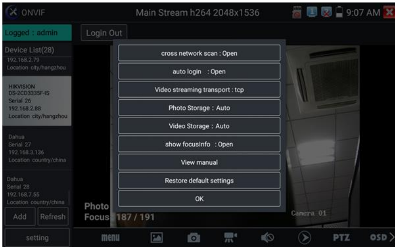
Рис. 34 Настройки приложения ONVIF
