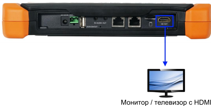
Рис. 15 Подключение тестера к HDMI-монитору
