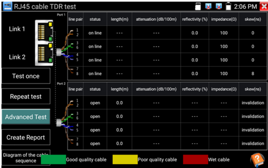
Рис. 117 Детальный тест кабеля (Advanced test)
