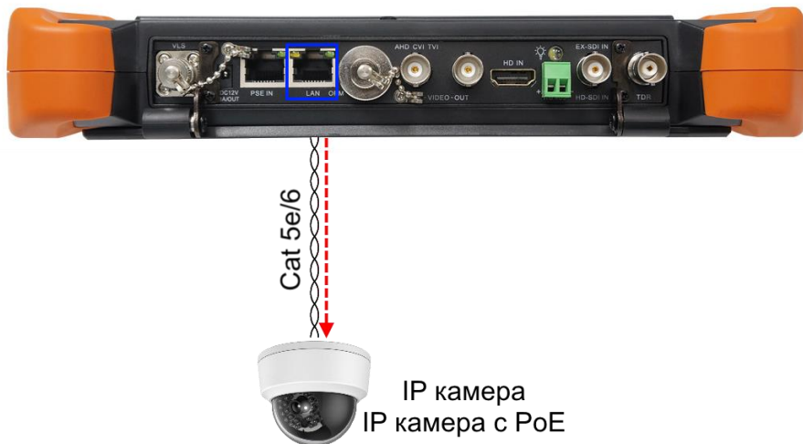
Рис. 7 Подключение IP-видеокамеры к тестеру
