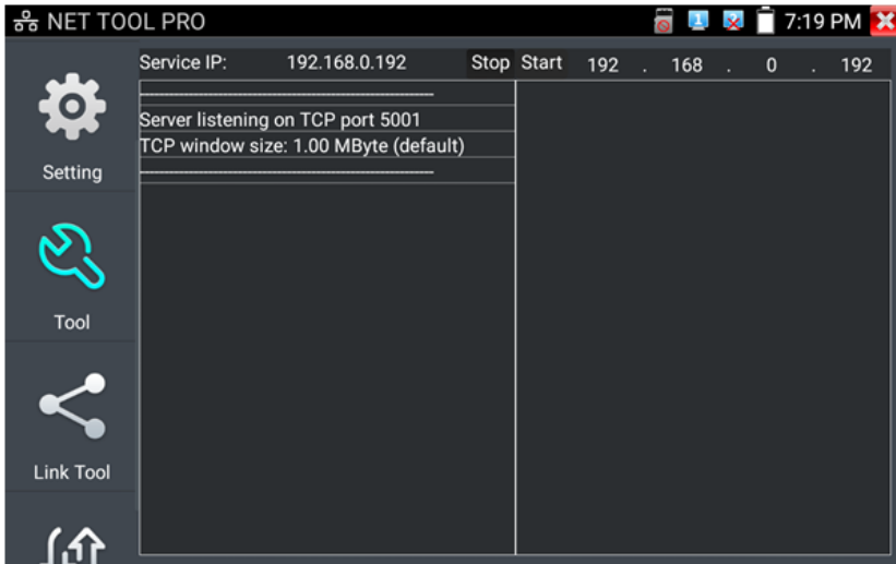
Рис. 107 Результаты тестирования пропускной способности, ПК в качестве клиента.
