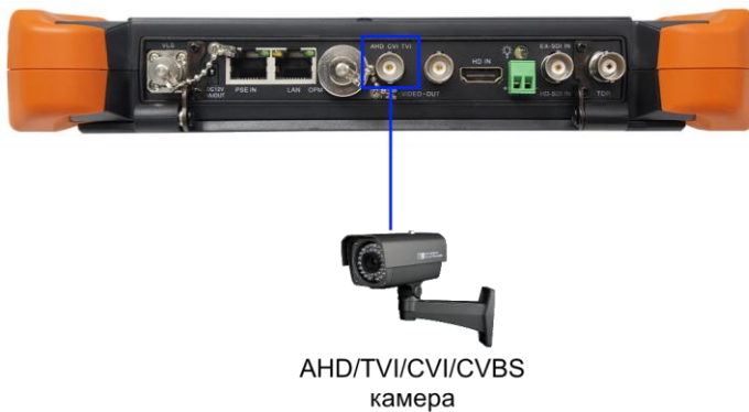
Рис. 12 Подключение AHD/TVI/CVI/CVBS видеокамеры к тестеру
