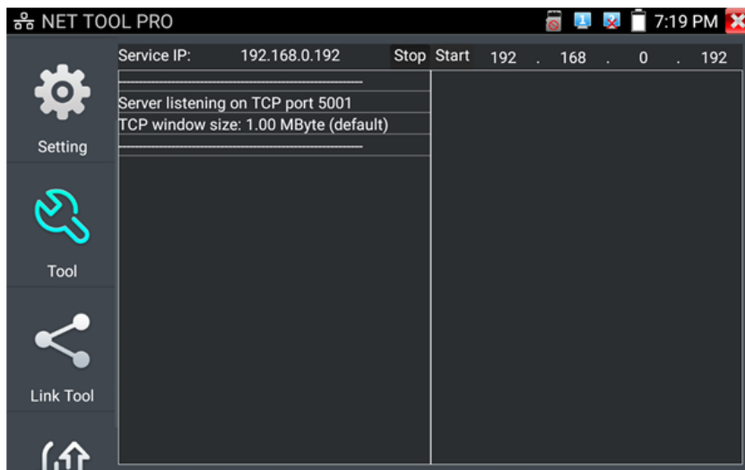
Рис. 104 Работа 1го тестера в режиме «сервер» при проверке пропускной способности сети
