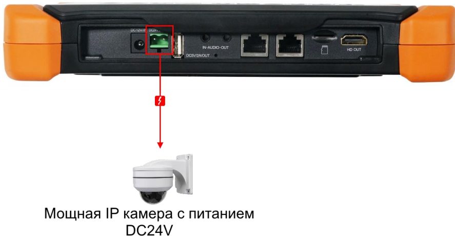
Рис. 10 Подключение питания к мощной IP-видеокамере без PoE
