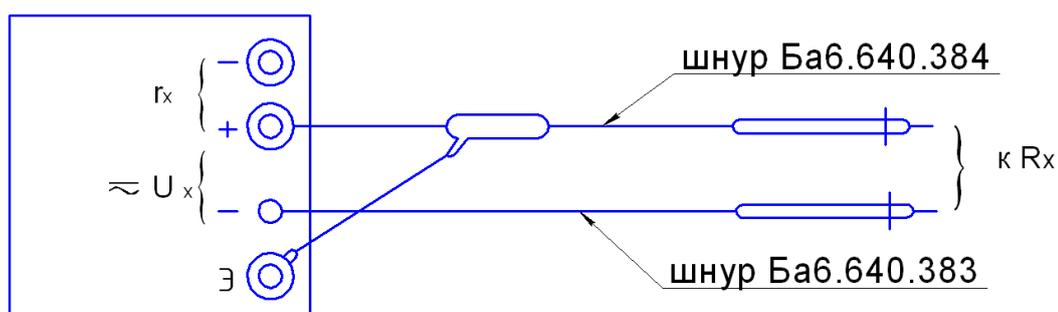
**Рисунок 1.2** – Подключение мегаомметров ЭС0210/5, ЭС0210/5-Г для измерения напряжения.
