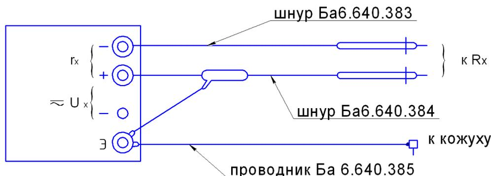
**Рисунок 1.3** - Подключение мегаомметров ЭС0210/5, ЭС0210/5-Г для измерения сопротивления.
