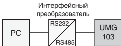
Рис. Подключение UMG103 к ПК через интерфейсный преобразователь.
