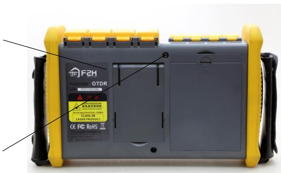
Рисунок 2 – Место пломбирования от несанкционированного доступа
