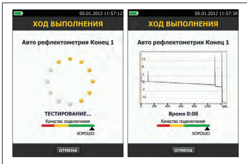
Рис. 11. Показателя уровня соединения с портом рефлектометра и экран "Ход выполнения"
