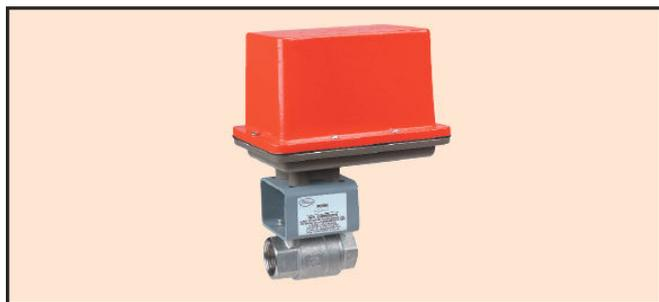
**Серия BV2B** содержит в себе атмосферостойкий, NEMA 4X, электрический привод со стандартным питанием 115 В переменного тока. Серия BV2B представляет собой экономичный атмосферостойкий клапанный узел. Параметрический привод имеет вход 4-20 мА для получения большого количества положений клапана. Привод имеет однофазный конденсаторный двигатель с защитой от перегрузки и постоянно смазываемую зубчатую передачу.
