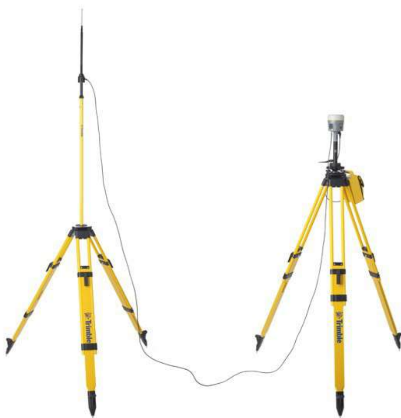
Присоединение кабеля внешней антенны к приемнику
