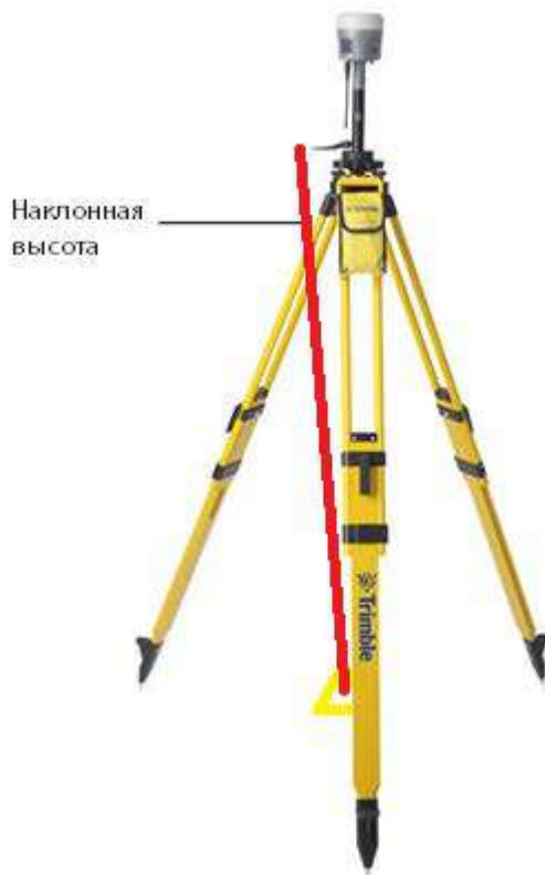
Установка приемника с внутренним УКВ радио на штативе (измерена наклонная высота)
