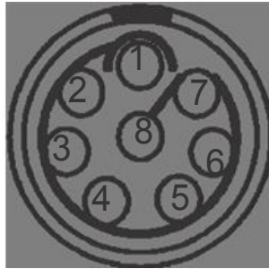
Рис. А-2. Разъем последовательного (COM) порта RS232
