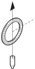
Точка отвесной линии над местом установки тахеометра.
