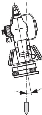
Угол между отвесной линией и направлением оси вращения тахеометра.
