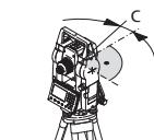
Коллимационная ошибка представляет собой отклонение от 90 градусов угла между осью вращения трубы и осью визирования. Эта погрешность устраняется измерением при обоих кругах.
