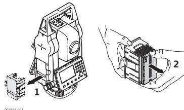
Онимите батарейный блок с прибора (1).
