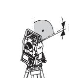
Отчет по вертикальному кругу должен равняться точно 90 $\circ$  (100 град) при горизонтальном положении визирной оси. Любое отклонение от этого значения называется местом нуля (i).
