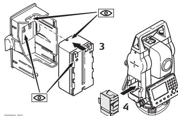
Вставьте другой аккумулятор в батарейный отсек (3) так, чтобы контакты были обращены наружу. Аккумулятор должен вставляться до щелчка.
