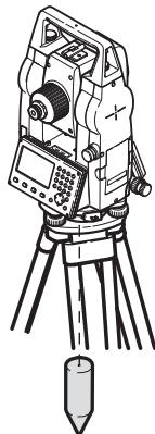
Направление действия силы тяжести. Коменсатор приводит ось вращения тахеометра в отвесное положение
