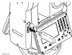
Поднимите заглушку USB-порта на тахеометре
