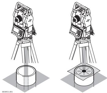
В некоторых случаях лазерное пятно отвеса не может быть видимым например, при центрировании тахеометра над вертикальными трубами. В этой ситуации можно использовать прозрачную пластину для проектирования на нее луча лазерного отвеса и приведения его направления на геометрический центр трубы или колодца.
