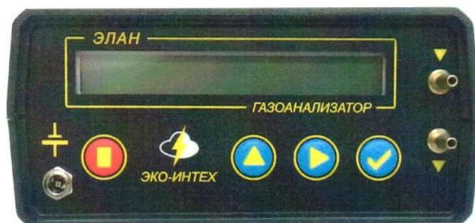
Рисунок 1 - Внешний вид (передняя панель) газоанализатора ЭЛАН
