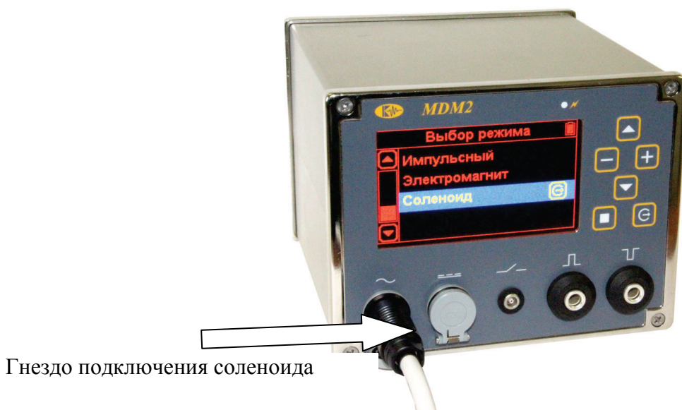
Рис 4.8 Подключение соленоида к дефектоскопу
