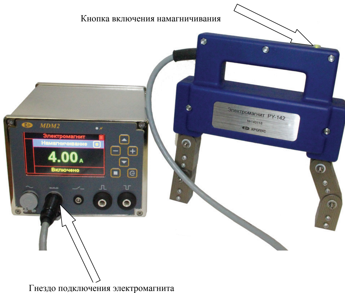
Рис 4.7 Подключение электромагнита к дефектоскопу
