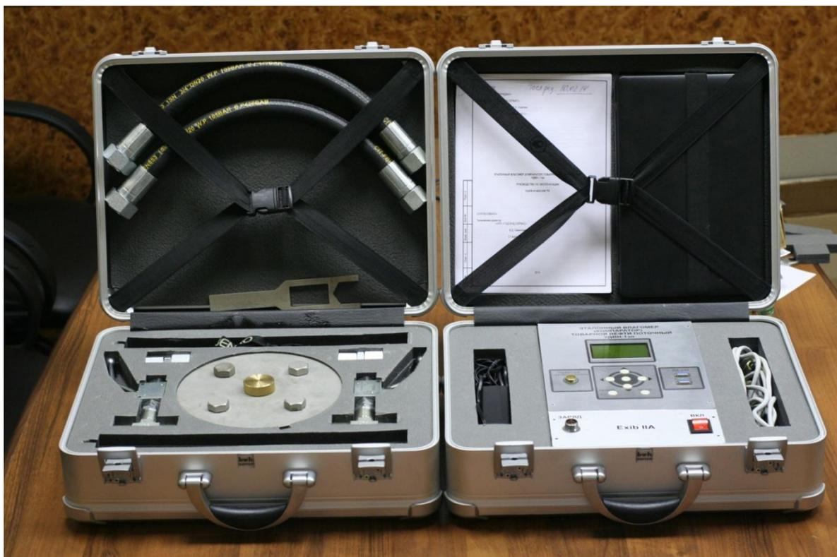
Влагомер эталонный (компаратор) товарной нефти поточный УДВН-1эп
