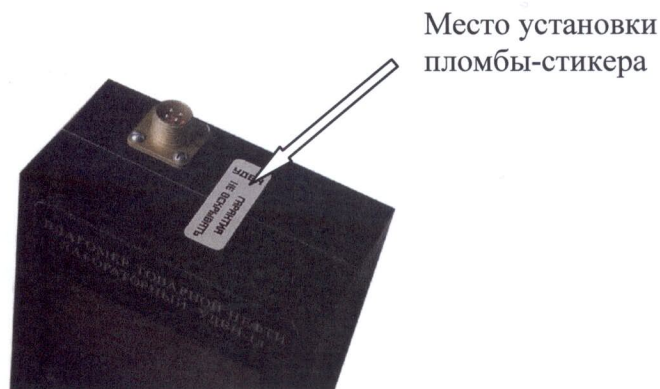
Рисунок 2 - Место пломбирования влагомеров нефти лабораторных УДВН-1л
