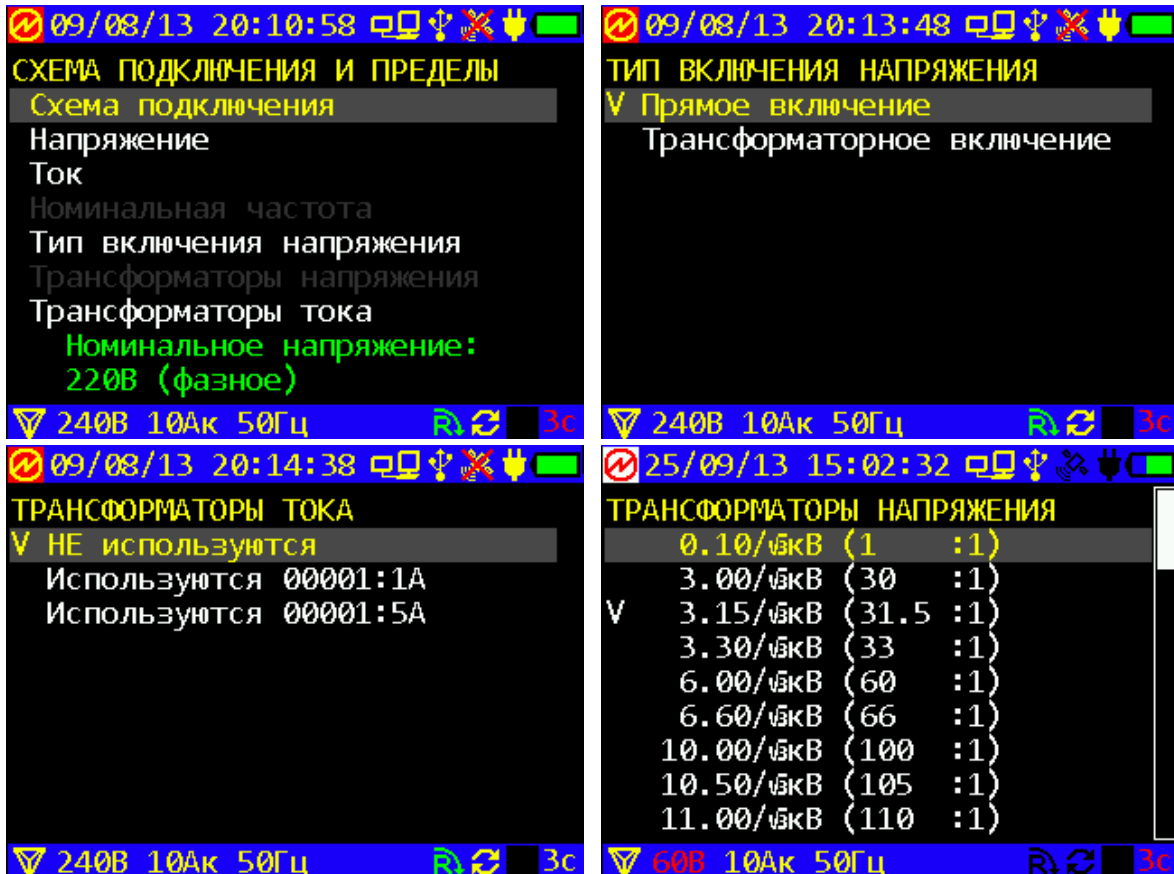
Рисунок 4.4.4 - Экраны для выбора трансформаторов
