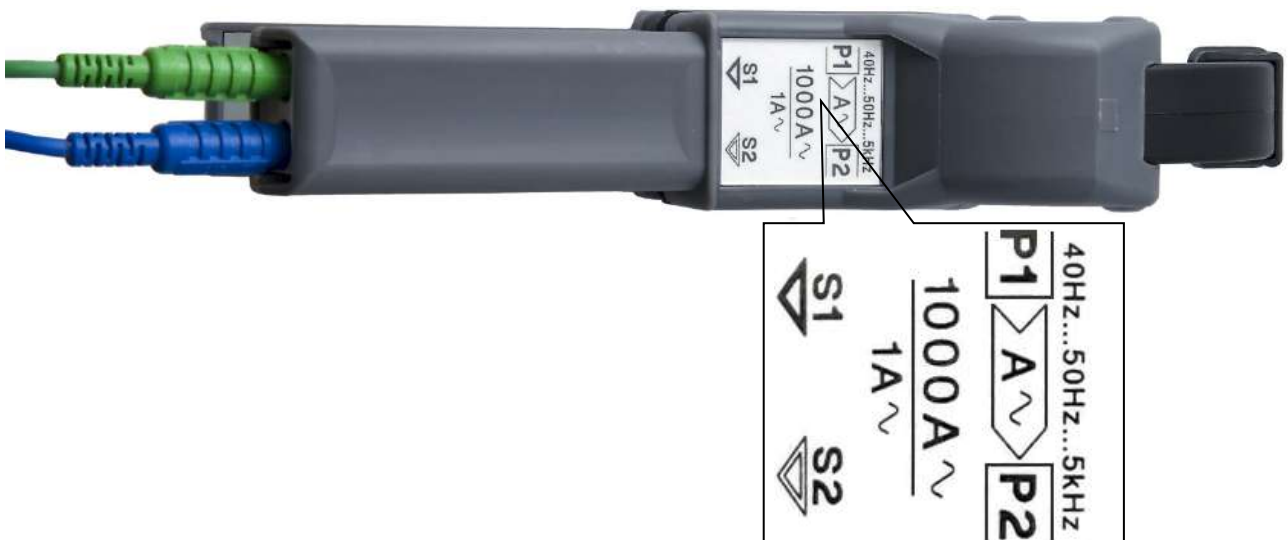
Рисунок А6 Расположение маркировки «генератор → нагрузка» на токоизмерительных клещах 1000А.
