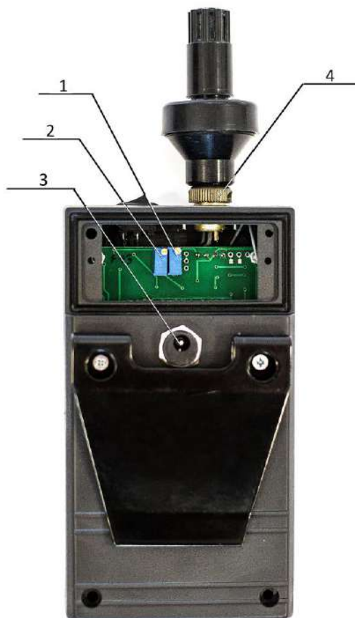
Рис.3. Вид газоанализатора СИГНАЛ-4М сзади со снятой крышкой.
