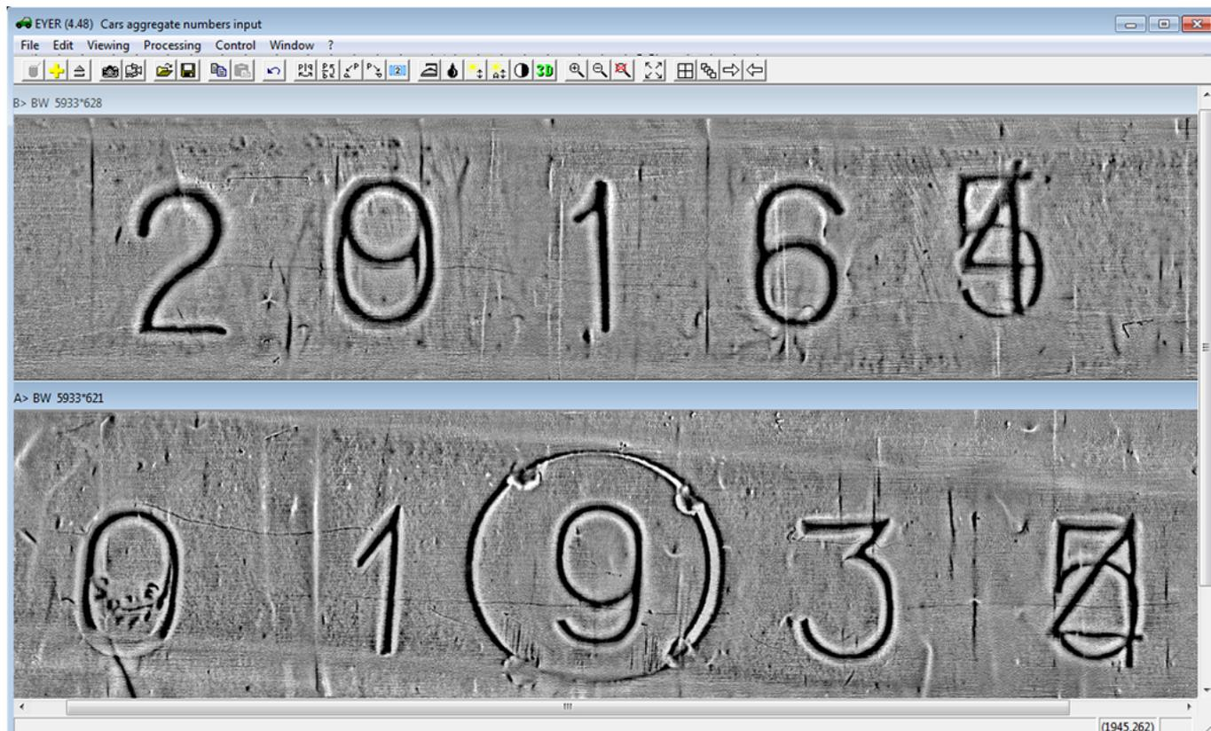
**Неразрушающее исследование поверхности металла для определения подлинности и выявления признаков фальсификации VIN-номеров, маркировочных обозначений оружия и боеприпасов, восстановление первичных номеров, контроль документов на автотранспортные средства и оружие.**
