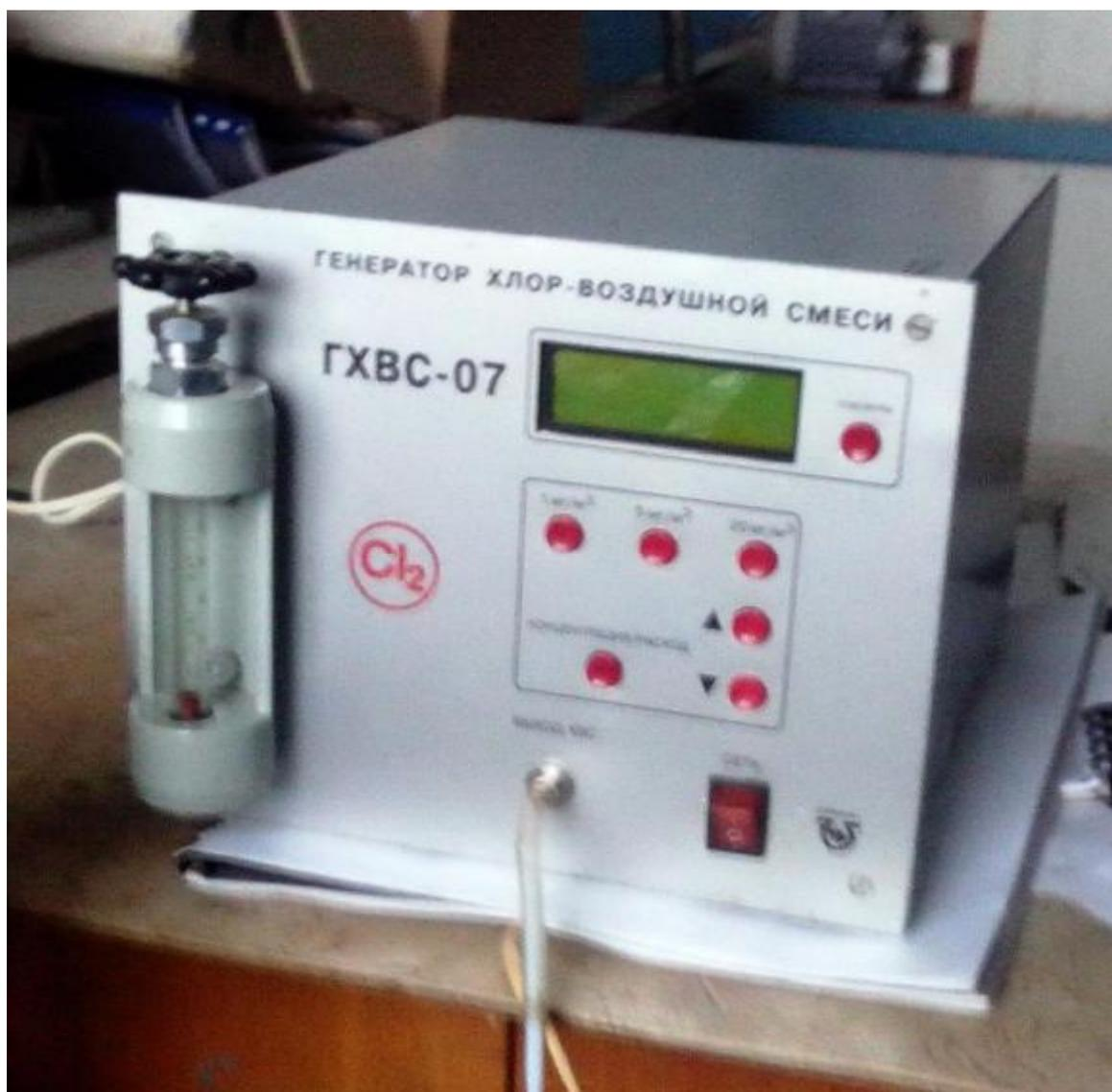
Рис. 1. Внешний вид генератора хлор-воздушной смеси GXBC-07
