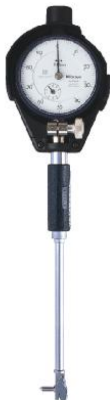
Рисунок 1 – Общий вид нутромеров серии 511 для измерений малых отверстий с головкой измерительной серии 2
