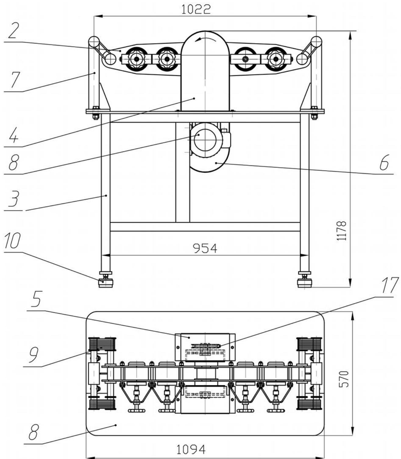
2 – Вибратор; 3 – Рама; 4...6 – Кожуха; 7 – Кронштейн; 8 – Двигатель;
