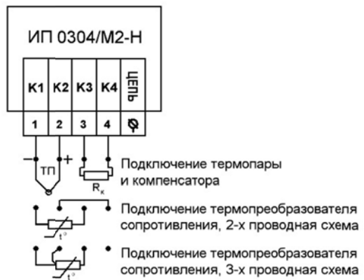
Рисунок А.1 – Подключение ПП к ИП 0304/М2-Н
