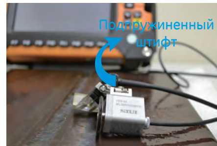
Подпружиненное крепление для хорошего контакта с объектом
