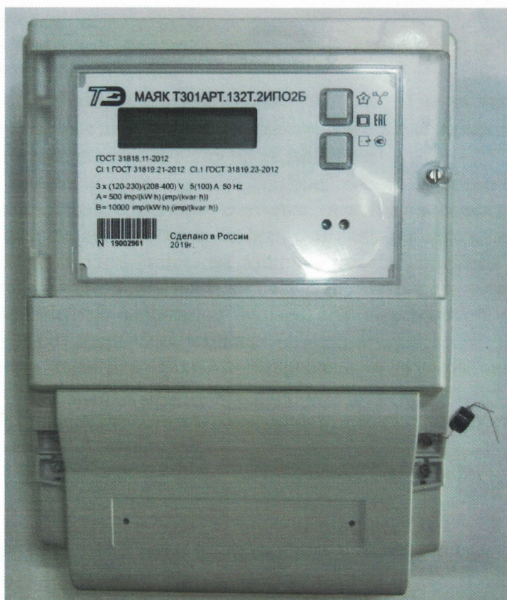
Рисунок 1 – Общий вид счетчика электрической энергии трехфазного статического МАЯК Т301АРТ
