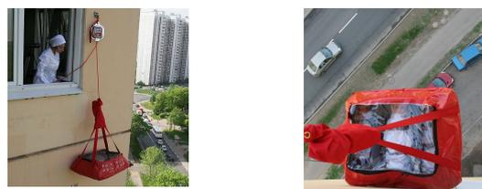
Рис.3 Эвакуация с применением УКСПА САМОСПАС
