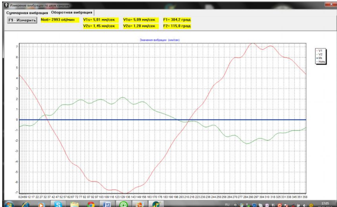
Рис. 7.43. Рабочее окно для вывода графиков оборотных составляющих вибрации.
