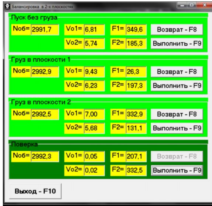
Рис. 7.18. Рабочее окно, используемое для измерений при балансировке в 2-х плоскостях.
