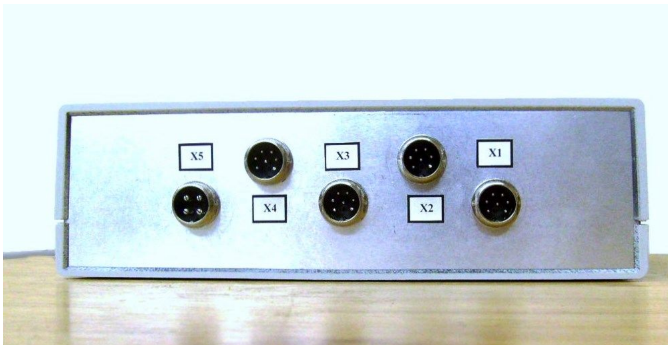
Рис. 4.2. Лицевая панель измерительного блока прибора «БалКом-4».
