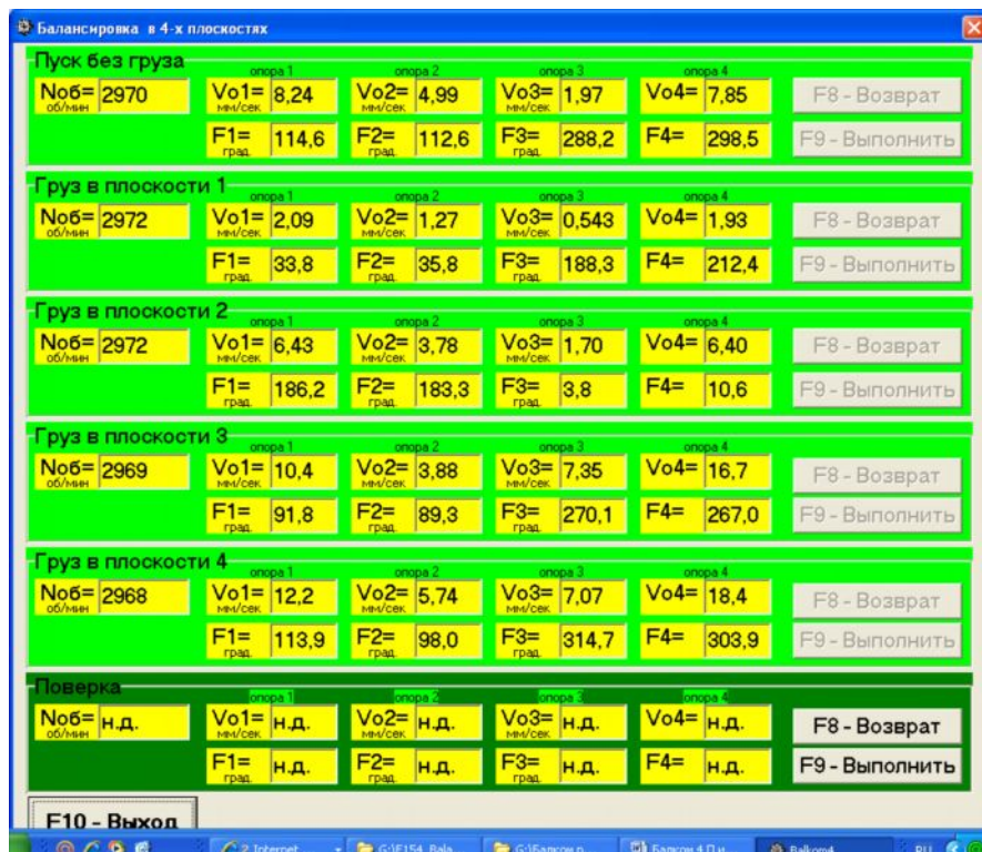
Рис. 7.34. Рабочее окно, используемое для измерений при балансировке в 4-х плоскостях.
