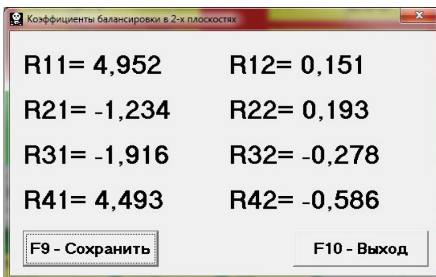
Рис. 7.10. Рабочее окно с коэффициентами балансировки в 2-х плоскостях.
