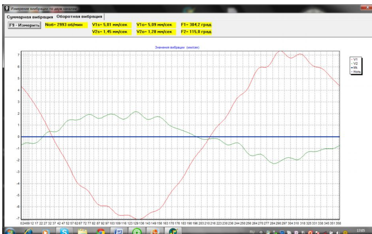
Рис. 7.16. Рабочее окно для измерения оборотных составляющих вибрации (силы).
