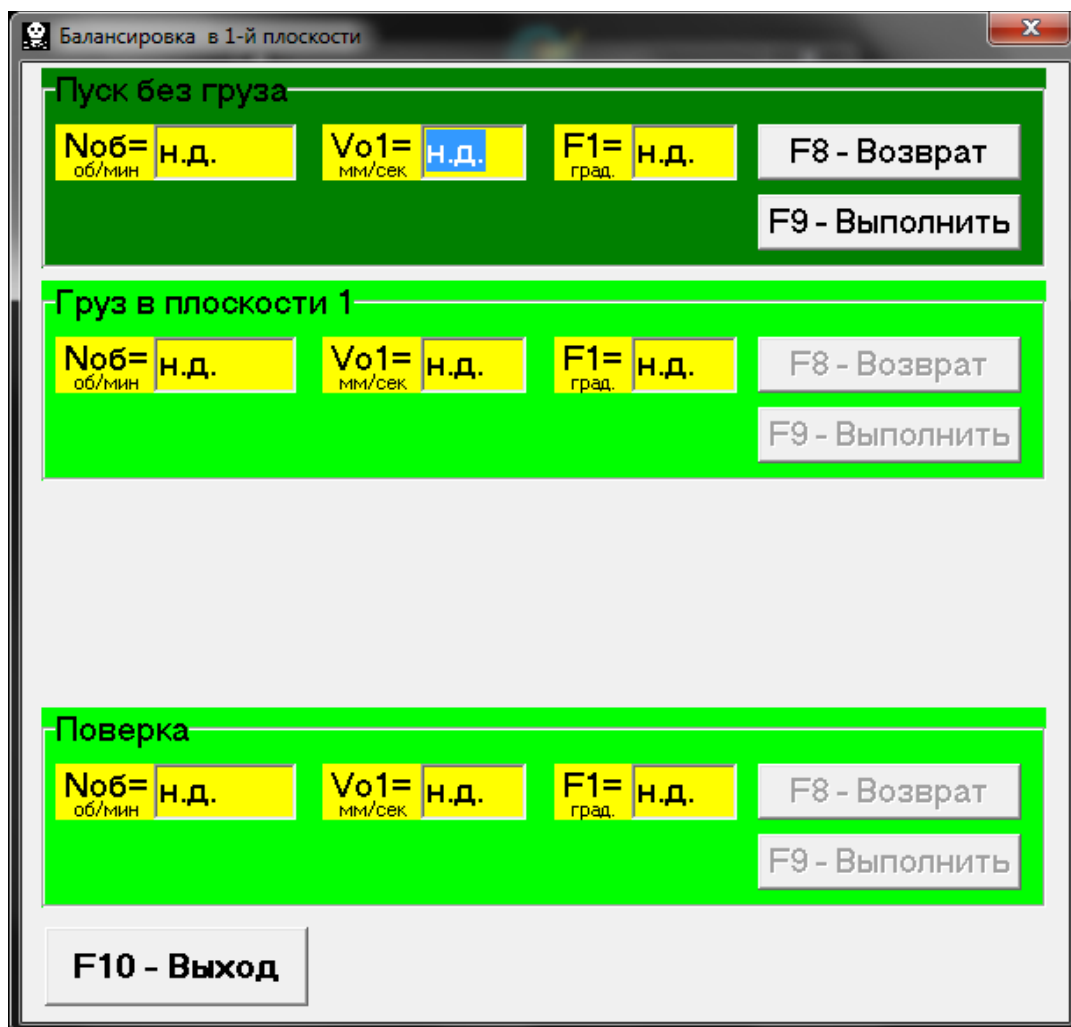
Рис. 7.6. Рабочее окно, используемое для измерений при балансировке в одной плоскости.
