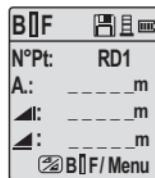
Pour démarrer une mesure en 'visée intermédiaire', configurer l'option 'Visée intermédiaire' sur ON ou presser la touche Altitude et Distance.
