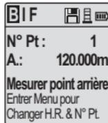
Mesure de point en visée arrière avec message d'invite
