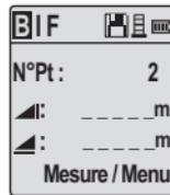
Mesure de point en visée arrière ou prochain point pivot avec message d'invite
