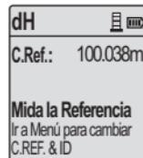
Medición hacia la referencia con mensaje de notificación
