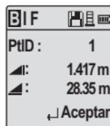
Visualización de la medición a la espalda con mensaje de notificación
