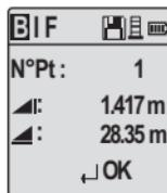
Affichage de mesure de point en visée arrière avec message d'invite
