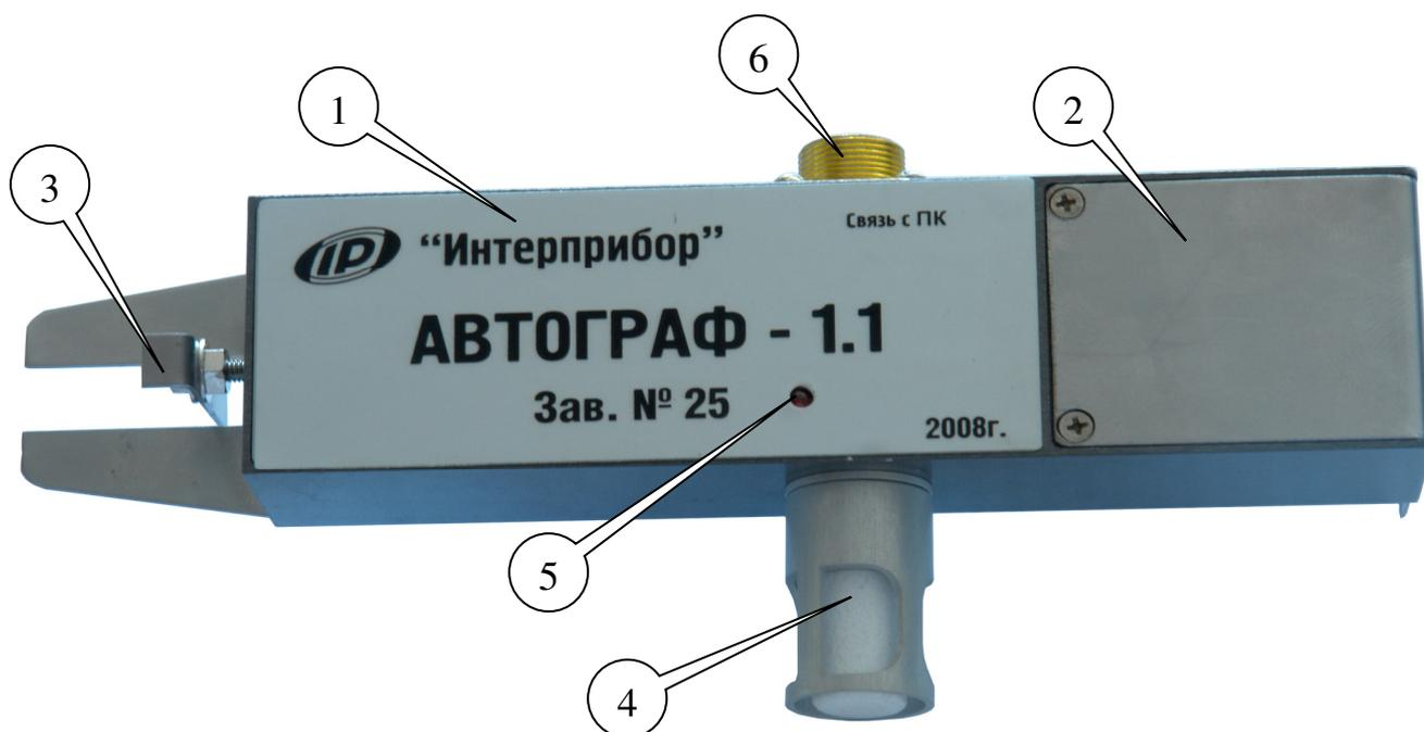
Прибор состоит из алюминиевого корпуса, разделенного на два отсека. Отсек 1 содержит блок измерительной электроники и датчик усадки. Отсек 2 доступен для открытия пользователем, в нем установлен высокотемпературный литиевый элемент питания. Из основания вниз
