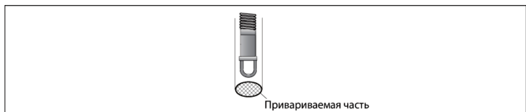
Рис. 31. Привариваемая часть термогильзы
