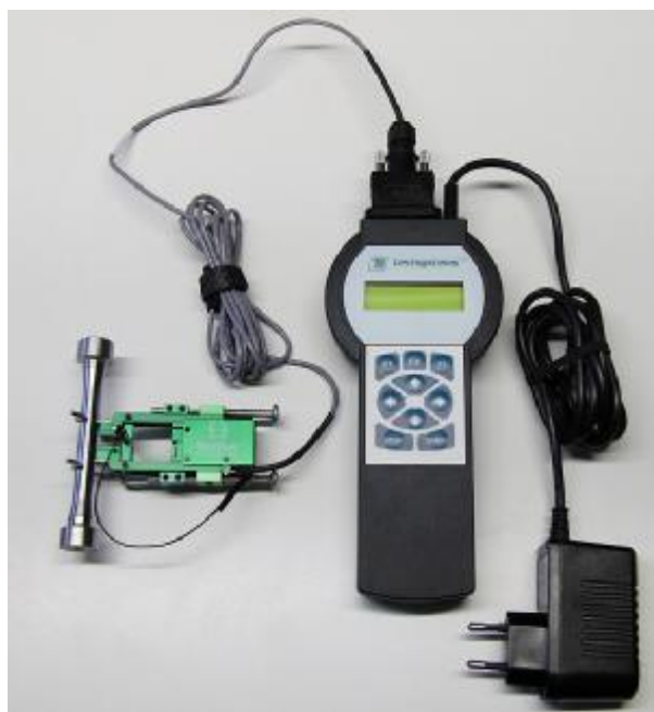
Рисунок 1. Внешний вид измерителей перемещений (деформаций) навесных ТС703
