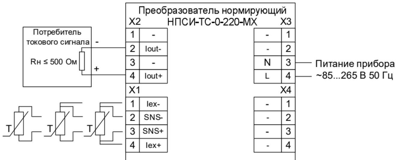
Рисунок 3 – Электрическая схема подключения преобразователей
