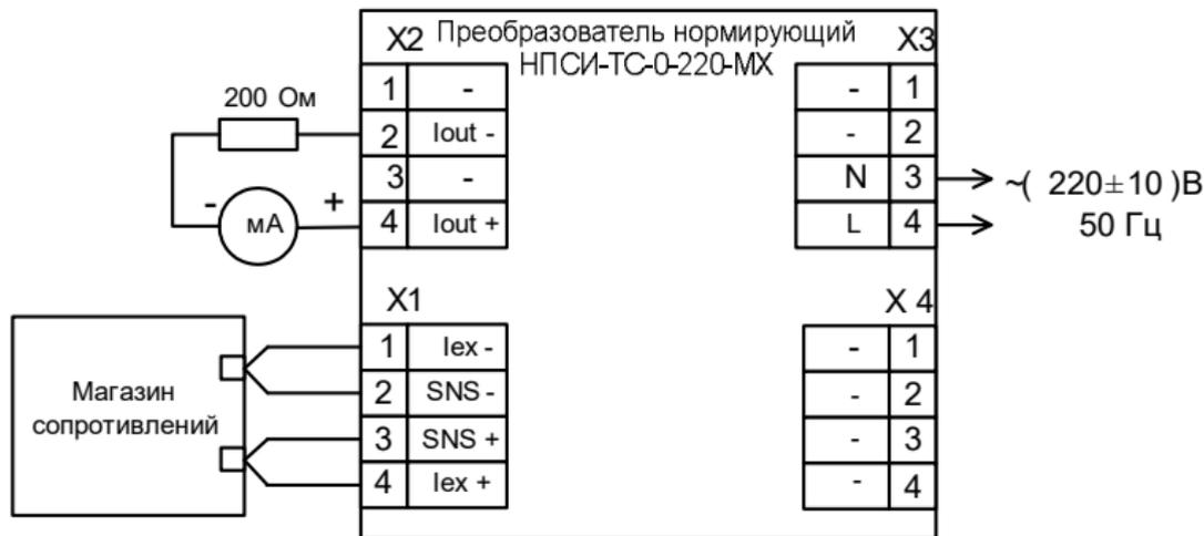
Рисунок 6.3.1 – Подключение преобразователя НПСИ-ТС-0-220-МХ для проведения поверки
