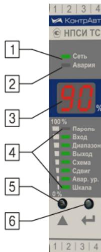
Рисунок 1 – Органы индикации и управления преобразователей
