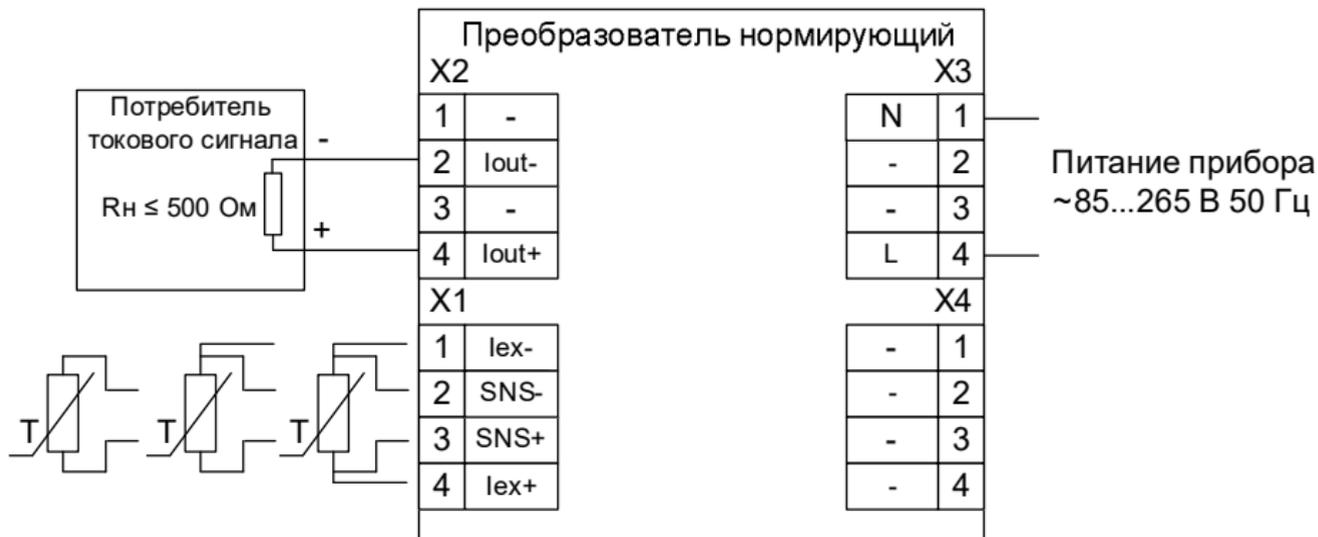
Рисунок 4 – Электрическая схема подключения преобразователей
