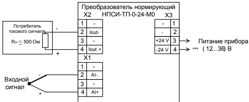
Рисунок 4 – Электрическая схема подключения преобразователей НПСИ-ТП-0-24-Х
