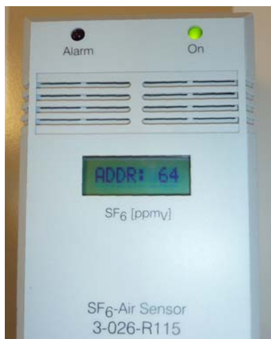
Рис. 4.7 Отображение адреса шины 64 на сенсоре элегаз-воздух подключенном к сети.
