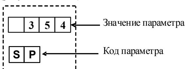
В показанном примере параметр **уставка** имеет значение **354 °C** и мнемонический код **SP**
