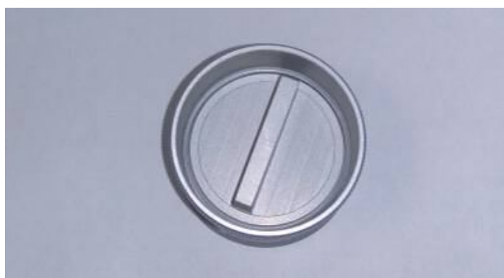
в) – Закрепление контрольного источника в держателе
