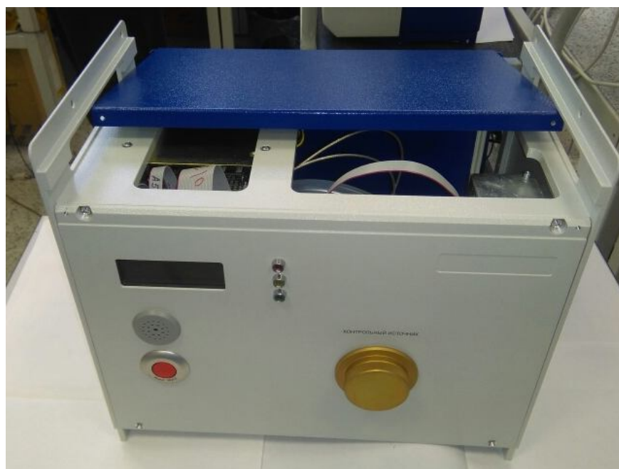
в) – Снятие верхней защитной панели
