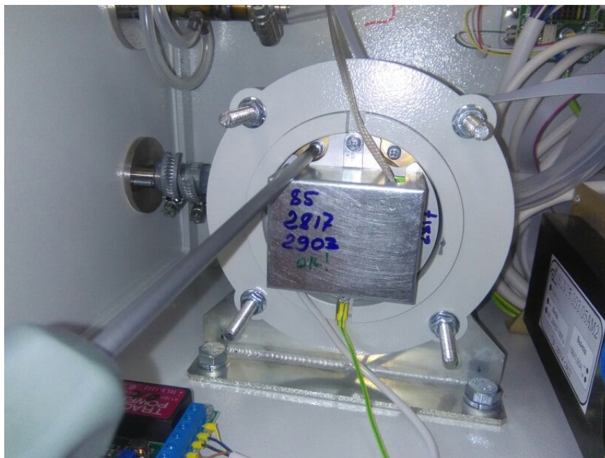
а) – Откручивание крепежных винтов блока детектирования
