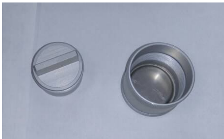
б) – Установка контрольного источника в держатель
