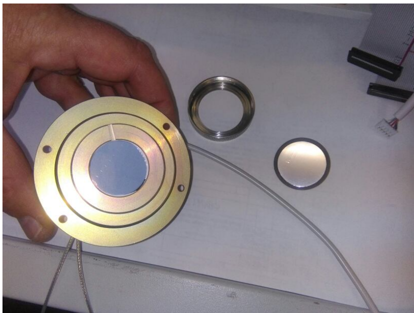
Рисунок 3.4 – Замена защитного кольца с плёнкой
