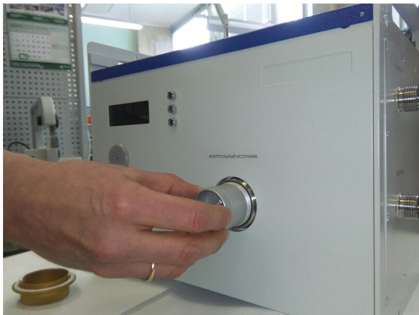
Рисунок 4.3 – Установка контрольного источника на штатное место
