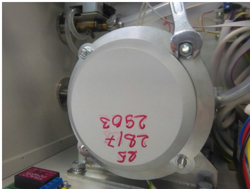
а) – Откручивание крепежных гаек защиты блока детектирования
