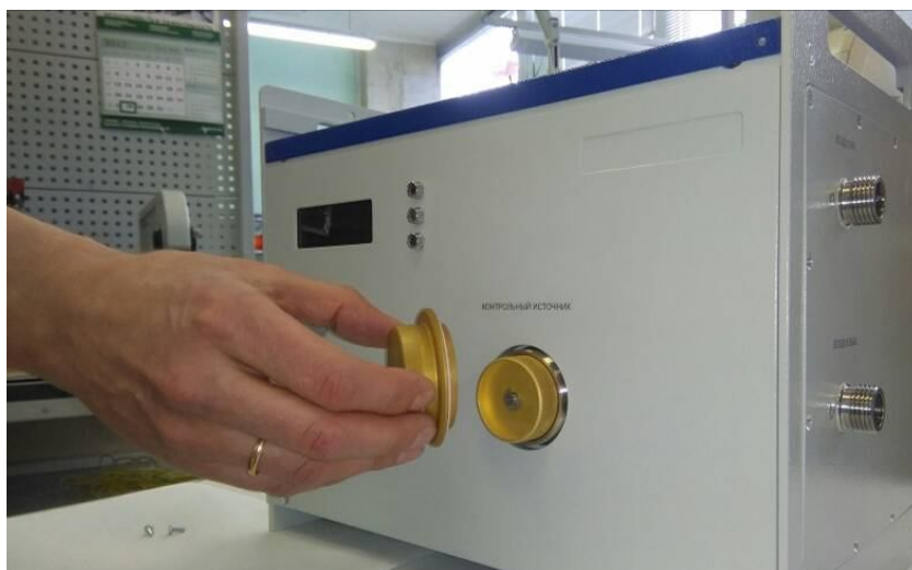
а) – Снятие защитной крышки
