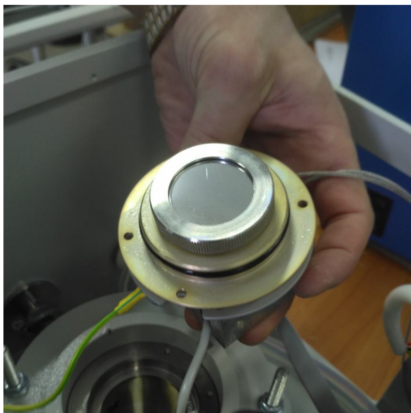
б) – Снятие блока детектирования
