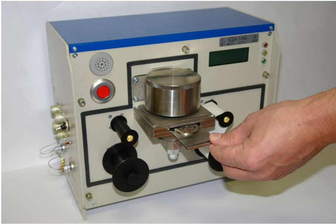
Рисунок 4.2 – Удаление сетки фильтра
