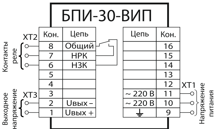
Рисунок В.1 — Схема подключения блоков БПИ-30-ВИП
