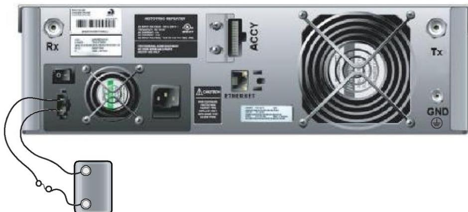
Рисунок 4 – Подключение резервного аккумулятора
